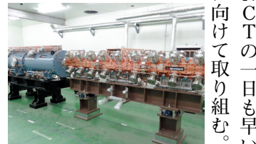
小型直線加速器(東海村:いばらき中性子医療研究センター)
