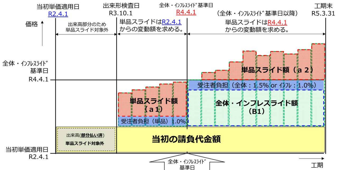
注)全体もしくはインフレスライドと併用する場合は、全体もしくはインフレスライドに基づく設計変更契約を先に行う。また、変動額算定に用いる当初設計時点の実勢価格は、全体もしくはインフレスライドの基準日の単価を用いる。
