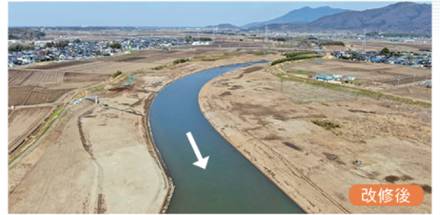
川幅を広げる河道掘削により、流下能力が向上：桜川（つくば市）
