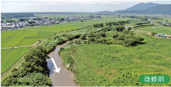
川幅を広げる河道掘削により、流下能力が向上：桜川（つくば市）
