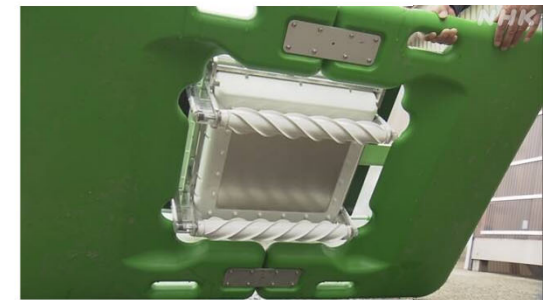
螺旋状スクリーンで、 稲を引き抜くことなく進む
